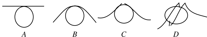
Рис. 8. Конформации полиэлектrolита, контактирующего с противоположно заряженной наносферой [32].
