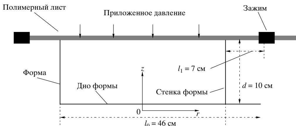
Рис. 1. Схема процесса термоформования полимеров под давлением.
