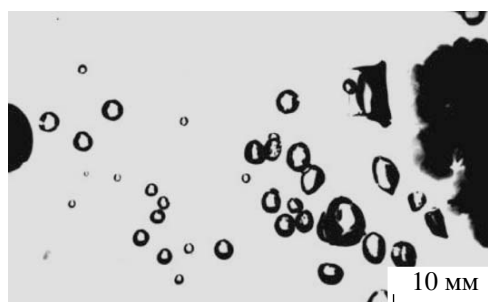
Рис. 4. Деформация пузырьков газа, вызванная усадкой геля. Фотография сделана после возвращения образца на Землю.
