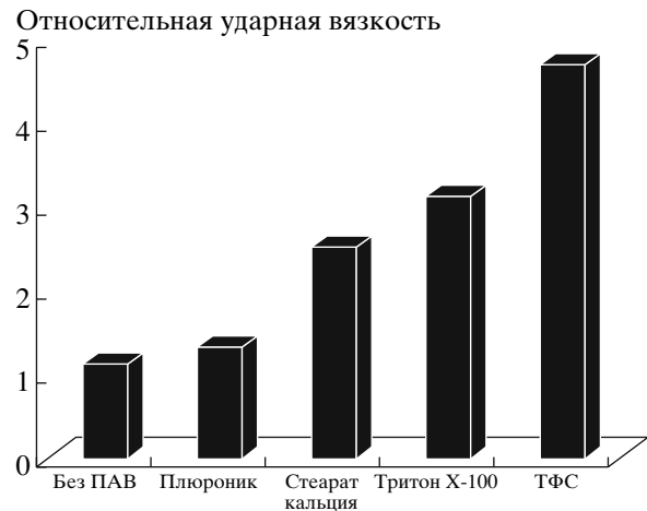
Рис. 9. Влияние природы ПАВ на степень упрочнения композита ПП– \text{nano-CaCO}_3 U1S2, содержащего 15 об. % наполнителя, при ударных нагрузках.
