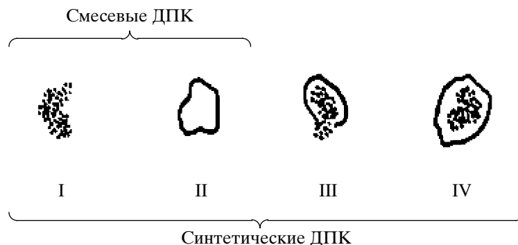
Рис. 4. Схематический разрез частиц дисперсной древесины (I), ПЭ (II), а также частиц дисперсной древесины, частично (III) и полностью (IV) покрытых ПЭ.
