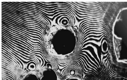
Рис. 8. Интерферограмма образца ПААГ вблизи газовых пузырьков. Направление инициирующего излучения – снизу вверх. Вертикальный диаметр центрального пузырька 2.3 мм.
