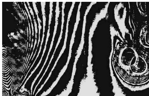
Рис. 9. Интерферограмма образца ПААГ вблизи омега-полимера (слева) и частиц геля (справа), возникших в мономере до начала фотополимеризации. Направление иницирующего излучения – снизу вверх. Размер одной частицы геля 1.6 мм.
